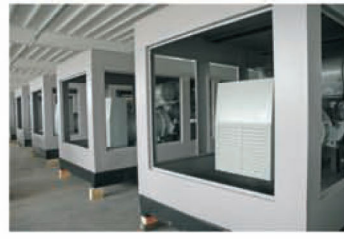
76 Db. e Kadar Jeneratör Kabinleri
